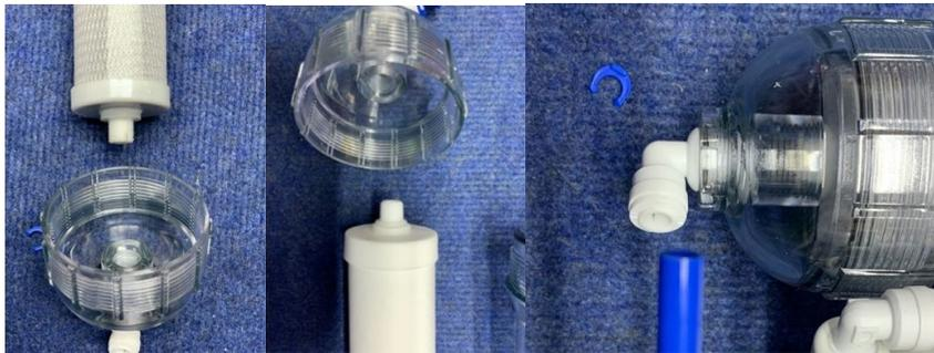
Drehen Sie das Filtermedium vorsichtig ein, bis ein leichter Widerstand fühlbar ist, optisch daran erkennbar, dass der Dichtungsring das Gehäuse und das Filtermedium berührt. Jetzt drehen Sie eine  $\frac{1}{4}$  Umdrehung weiter zu.
